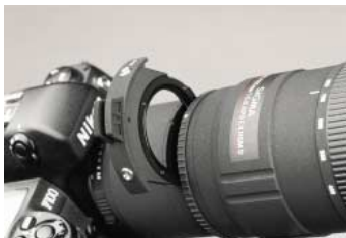
In posizione arretrata è estraibile un cassetto per filtri a vite di diametro 46mm. Davanti al cassetto c'è una ghiera che permette la rotazione del filtro già montato, una soluzione utile per i filtri polarizzatori.
