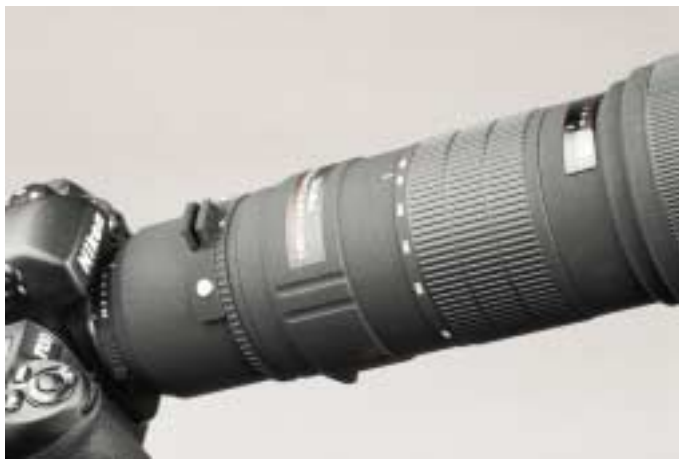
Il corpo dell'ottica. Le ghiera di variazione focale e di messa a fuoco operano spostando i gruppi ottici interni e l'obiettivo non si allunga durante le regolazioni.
